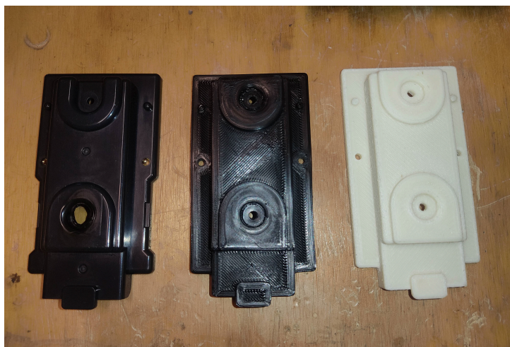
Original (links) und Iterationen des Ersatzteils aus dem 3D-Drucker
